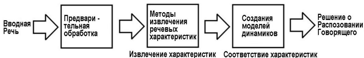
Рисунок 2 – Блок-схема системы распознавания говорящих
